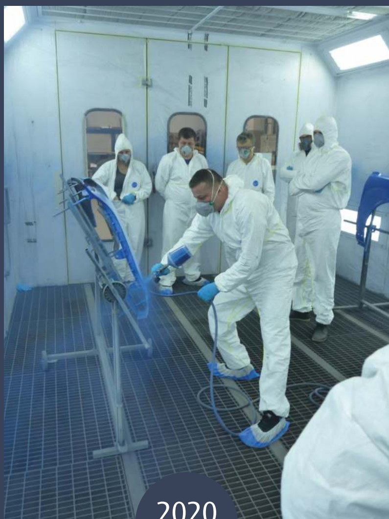
Proces lakierowania naprawczego elementów, przygotowanie podłoża z zabezpieczeniem antykorozyjnym, nanoszenie podkładów do aplikacji powłok dekoracyjnych
